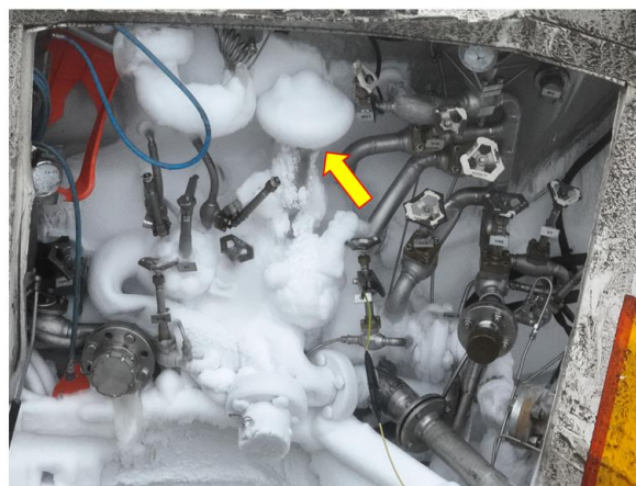
Kuva 21 Säiliöauton venttiilien operointi oli mahdotonta täysin jäätyneiden komponenttien vuoksi
